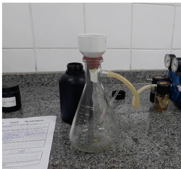
Figura 08. Esquema para a filtração do extrato glicólico
