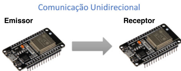
Figura 5. Representação do Sistema de Comunicação Ponto a Ponto
