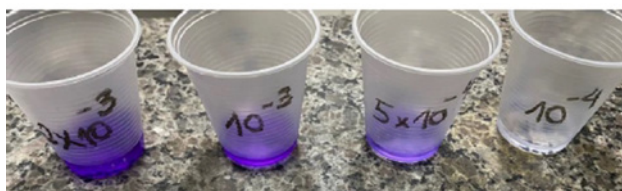
Figura 05. Soluções diluídas de violeta genciana em concentrações de 0,002%, 0,001%, 0,0005% e 0,0001%, da esquerda para direita.
